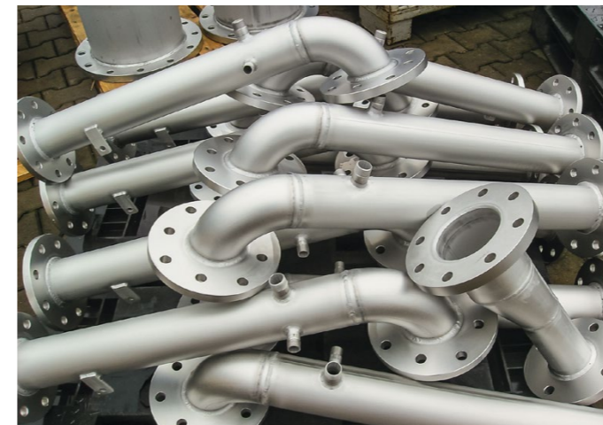
Formstückfertigung DN 100 bis DN 1000 Edelstahl
