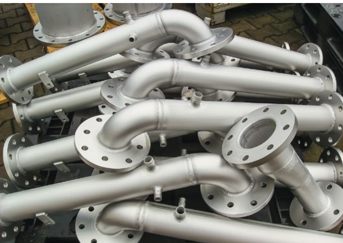
Formstückfertigung DN 100 bis DN 1000 Edelstahl
