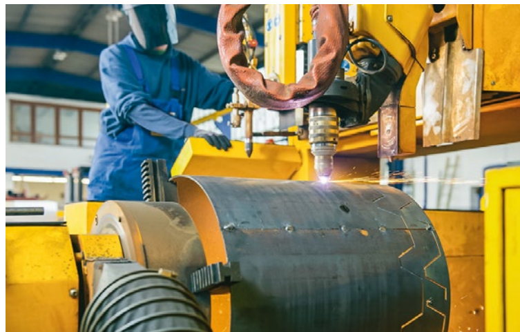
Plasma- und Autogenschneidanlage MICROSTEP: Rohrschnitte bis DN 600 und Blechdicken bis 60 mm
