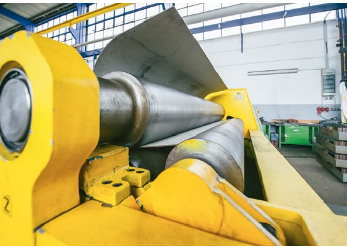
Walzenbiegemaschine für die Herstellung von Sonderanfertigungen - Rohre und Rinnen in U-Form
