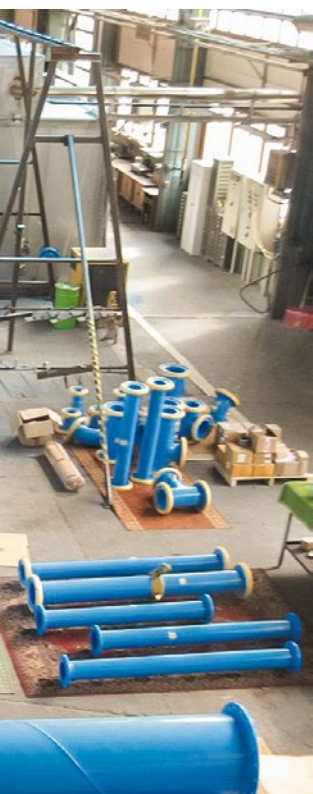
Formstückfertigung DN 100 bis DN 1000 Edelstahl
